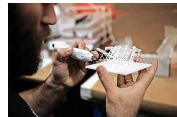
Jungunternehmer Tal Yemin reinigt bei den Impact Labs ein 3D-Druckteil von überschüssigem Material.
